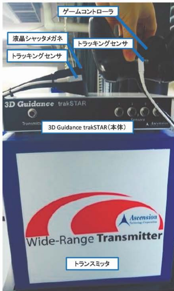
図4 トラッキングシステムの外観
