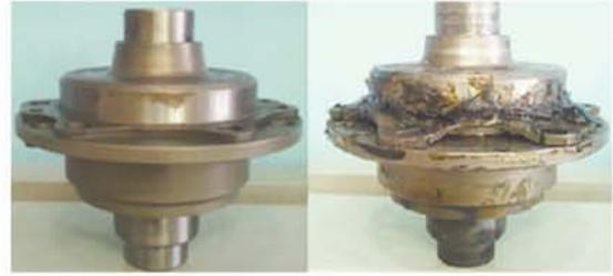
正常部品                      フランジ部破損
