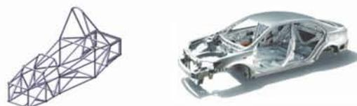
フレーム構造                      モノコック構造
