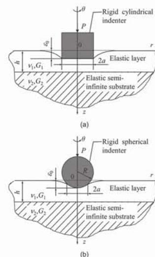
図1 弾性基質上の弾性層を剛体圧子で押し込む軸対称弾性接触問題
