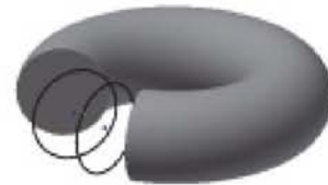
図5 トーラス断面（切れ刃）の変化
